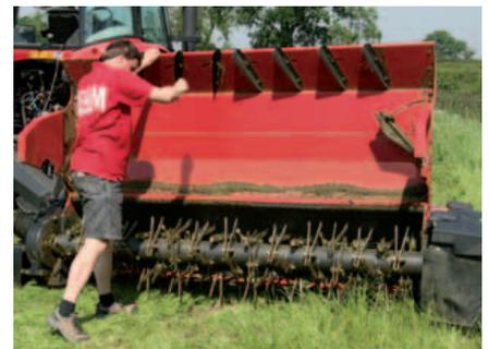
Das gesamte Heck des Mähers kann für einfachen Zugang zum Aufbereiter angehoben werden. Der Aufbereiterrotor kann für das Mähen ohne Aufbereitung sehr schnell vollständig ausgebaut werden.
