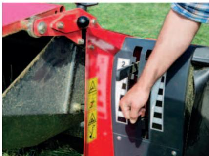
Die Aufbereiterplatte kann über zwei Drehpunkte eingestellt werden. Besonders praktisch bei großen Futtermassen.
