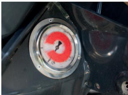
Die Bodendruckentlastung wird einfach hydraulisch aus der Schlepperkabine eingestellt. Der eingestellte Auflagedruck kann auf einer übersichtlichen Skala abgelesen werden.
