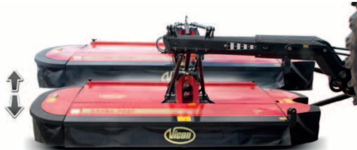
QuattroLink-Mähwerksaufhängung - Neues innovatives Konzept mittels spezieller Anlenkung für perfekte Boden Anpassung und absolut gleichmäßigen Auflagedruck. 700 mm vertikale Anpassung - 300 mm nach unten und 400 mm nach oben.
