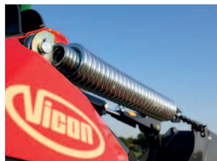
Die großen Spiralfedern sorgen für eine perfekte Boden Anpassung über die gesamte Arbeitsbreite.
