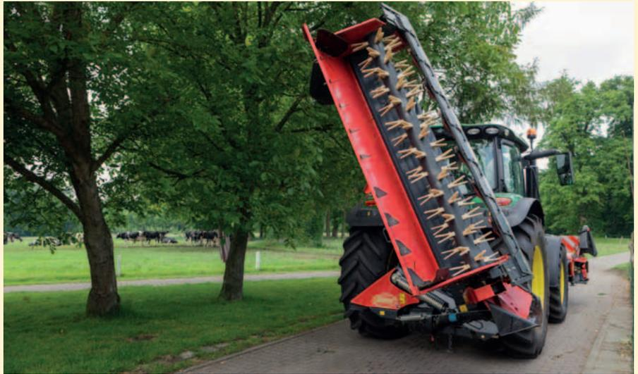
Für den Straßentransport wird das EXTRA 624T, 628T/R und 632T Farmer vertikal geklappt.
