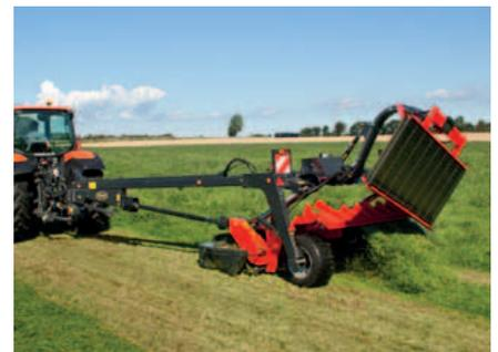
Beim ersten Durchgang wird ein normales Schwad abgelegt, wobei das Band aufrecht steht. Beim zweiten Durchgang wird das Band abgesenkt.
