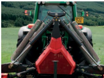
Vier groß dimensionierte Entlastungsfedern sorgen für eine gleichmäßige Entlastung über die gesamte Arbeitsbreite.
