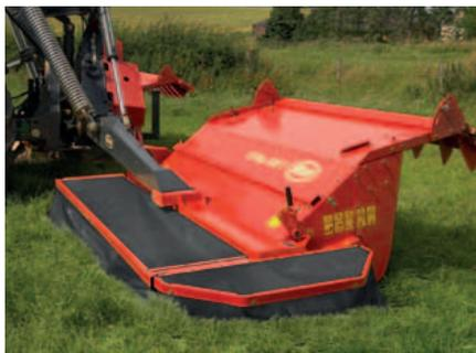
Die mittige Aufhängung der beiden hinteren Mäheinheiten sorgt für hervorragende Boden Anpassung.
