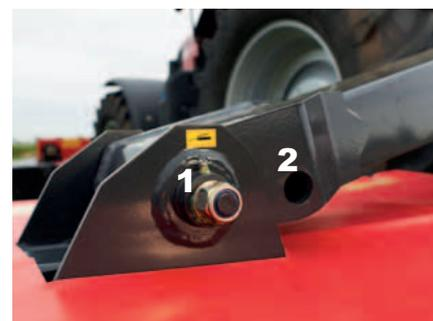
Zwei Anbaupunkte am Auslegearm für die Mäheinheit – für eine perfekte Überlappung mit dem Frontmähwerk.
