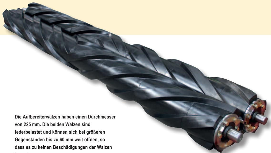
Die Aufbereiterwalzen haben einen Durchmesser von 225 mm. Die beiden Walzen sind federbelastet und können sich bei größeren Gegenständen bis zu 60 mm weit öffnen, so dass es zu keinen Beschädigungen der Walzen kommt.
