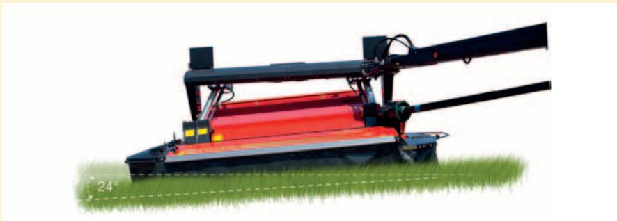
Die Entlastungsfedern garantieren auch eine einwandfreie seitliche Anpassung der kompletten Mäheinheit.
