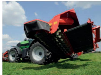
Trotz der Größe ist die EXTRAΔ 690T-Kombination am Vorgewende sehr einfach zu handhaben. Jede Einheit kann per einfacher Bedienung eines Knopfes in der Kontrollbox hochgeklappt werden.
