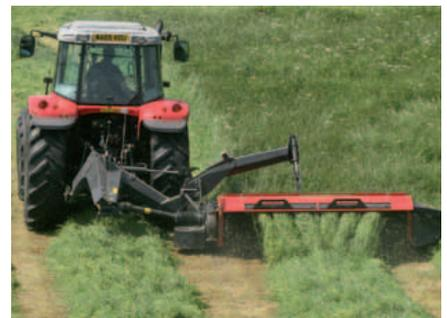
Durch Einstellung der Streuflügel kann das Mähgut in einem schmalen Schwad abgelegt werden.
