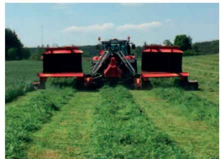
Wenn die Schwadverlegebänder nicht in Gebrauch sind, werden sie einfach hydraulisch nach oben geschwenkt.
