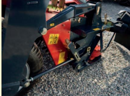
Die perfekte Mähwerksaufhängung sichert, dass sich die Mäheinheit nach oben und unten anpassen kann.
