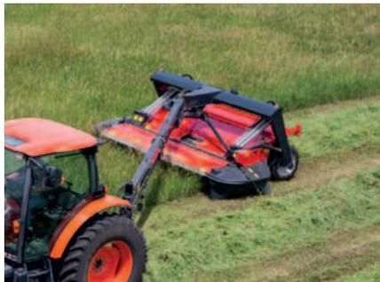
Das Mäherwerk kann rechts oder links neben dem Schlepper arbeiten,...
