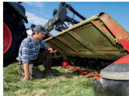
Schneller und einfacher Zugang zum Mähbalken für die tägliche Inspektion der Mähscheiben und Mähklängen.
