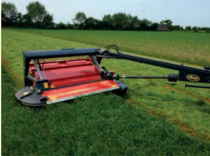
Am starr gebauten Hauptrahmen befinden sich keine beweglichen Teile was den Verschleiß auf ein Minimum reduziert.
