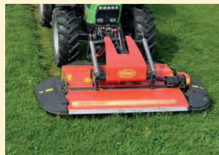
Darüber hinaus ermöglicht die innovative Aufhängung eine Queranpassung von 24° und gewährleistet somit eine hervorragende Anpassung des Gerätes an unebene Bodenkonturen sowie höhere Arbeitsgeschwindigkeiten.
