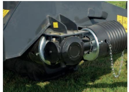
Die Zapfwellengeschwindigkeit kann durch Drehen des Getriebes von 540 auf 1.000 U/min geändert werden.
