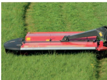
Die Mittenaufhängung garantiert einen gleichmäßigen Auflagedruck über die gesamte Arbeitsbreite.
