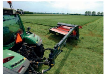
Der Schwenkdeichselkopf mit Umkehrgetriebe sorgt für optimale Wendigkeit.
