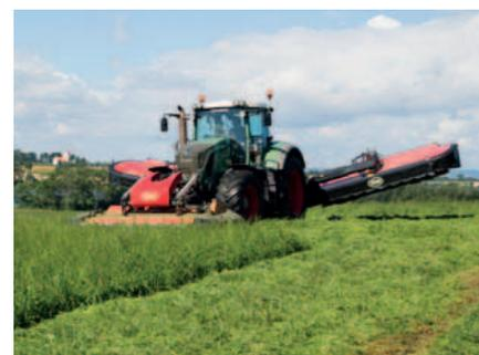
Vorgewendemanagement – die Heckmäherwerke heben zeitversetzt zum Frontmäherwerk aus bzw. ein.
