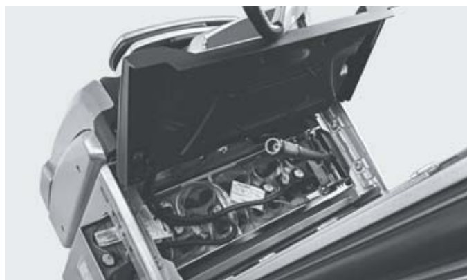
Rychle a bezpečně: inovativní zajištění baterie umožňuje rychlou výměnu baterie bez rizika skřípnutí
