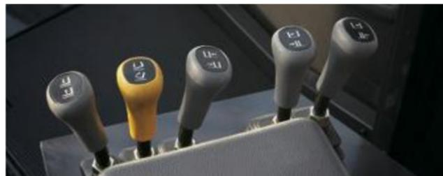
Les chariots équipés avec un équipement à déplacement latéral ont un positionneur de fourches hydraulique ayant cinq leviers de manutention de charge. La suppression du commutateur de sélection offre une manœuvrabilité améliorée.
