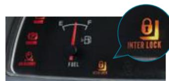
Un vibreur d'alerte retentit si le conducteur quitte son siège lorsque le commutateur du démarreur est en circuit. Après environ 3 secondes, la transmission sera bloquée au point mort, le système de manutention de charges désactivé et un témoin d'avertissement s'allumera.
