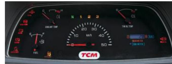
Le tableau de bord utilise des DEL pour l'éclairage, de manière à offrir une excellente visibilité et procurer une longévité de service plus longue que des ampoules. Un compteur kilométrique est affiché lorsque le commutateur du démarreur est mis en marche et que le commutateur est mis hors circuit. (Les compteurs commutent automatiquement du mode kilométrique au mode du compteur horaire lorsque le moteur commence à tourner.)
