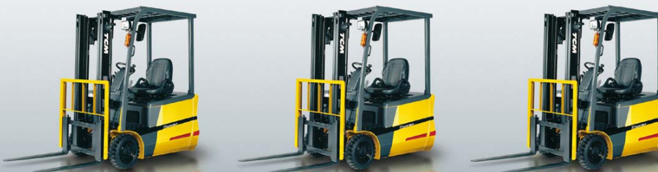
FTB16-7 Capacità max.: 1.600 kg (3.500lb) Baricentro: 500 mm (24 in.)
