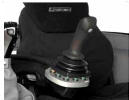
L'**accoudeur-joystick** optionnel permet de commander confortablement un chargeur ou le système hydraulique ou de changer le sens de la marche. Des micro-contacteurs permettent de sélectionner les diverses fonctions.
