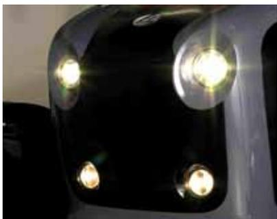
Le **GEOTRAC 124** est équipé de série de phares H7 et HB3 à **ellipsoïdes**. Les phares intégrés dans le toit assurent un éclairage optimal pour les travaux avec des outils à l'avant.
