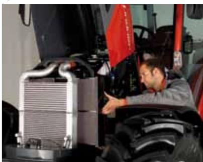
Conçu d'une pièce, le **capot moteur** s'ouvre de façon agréable et confortable grâce à l'assistance de vérins pneumatiques. **Les filtres fins extractibles** permettent un nettoyage confortable des radiateurs sans avoir à les rabattre.
