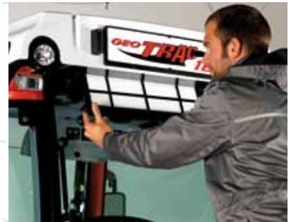
Disponible en option, la **climatisation** permet de régler confortablement la température ambiante. Le grand box réfrigérant situé sur le côté est réfrigéré en même temps. Le filtre est facilement accessible avec le relevage arrière.
