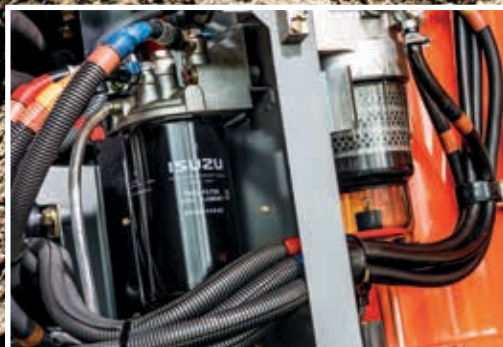
Il filtro principale del carburante è facilmente sostituibile.
