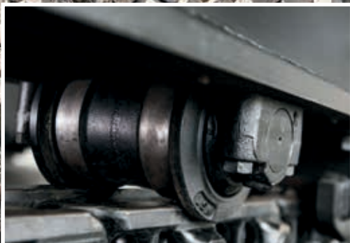
Il nuovo disegno del rullo inferiore evita i danni causati dall'intrusione di fango.
