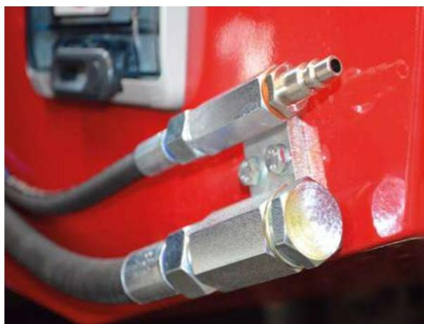
**Position pour commandes d'urgence de la partie aérienne et avec clé de fermeture pour garantir la maximale sécurité.**
