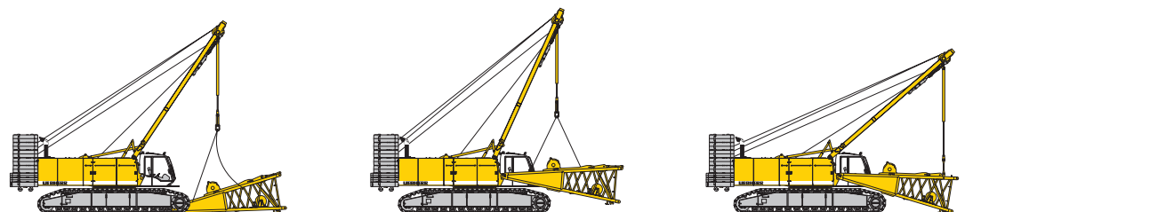
Déchargement et montage du pied de flèche
