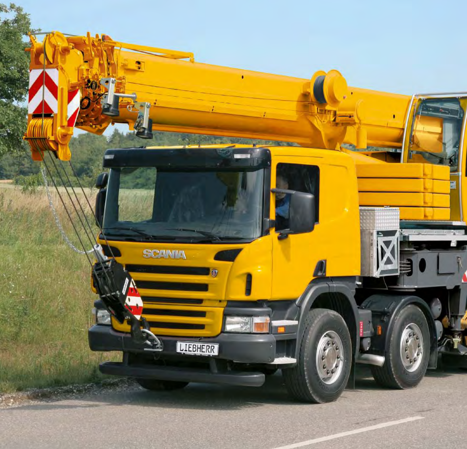
Umfangreiche Staukästen für Zubehör und Unterlegthölzer an Zwischenrahmen und an beiden vorderen Klappholmen
