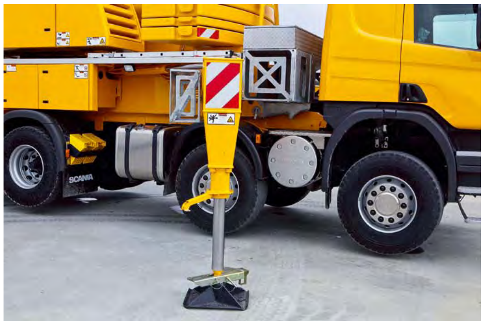
Option für Scania, MAN und Volvo: Staukasten kombiniert für Anschlagmittel und Unterlegthölzer
