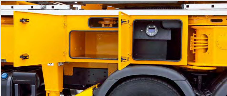
Umfangreiche Staukästen für Zubehör und Unterlegthölzer an Zwischenrahmen und an beiden vorderen Klappholmen
