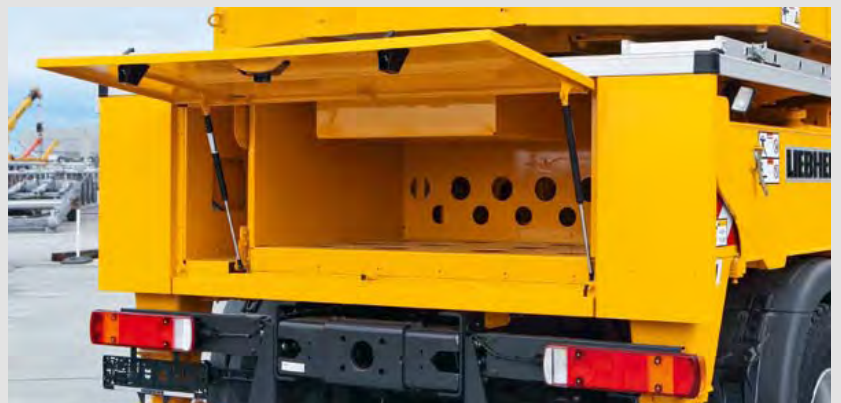
Option für Scania, MAN und Volvo: Staukasten kombiniert für Anschlagmittel und Unterlegthölzer
