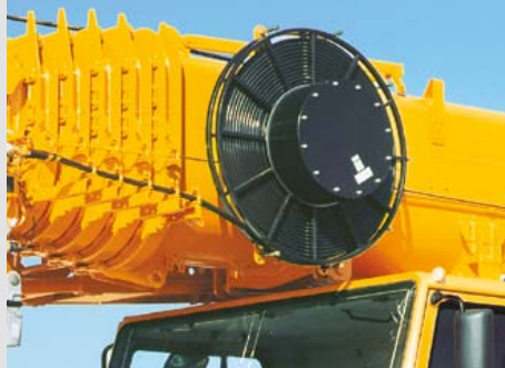
Барaban с шлангом для гидроцилиндра удлинителя
