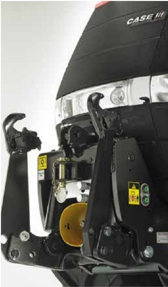
Voll integrierte Fronthydraulik mit einer Hubkraft von 5.000 kg.
