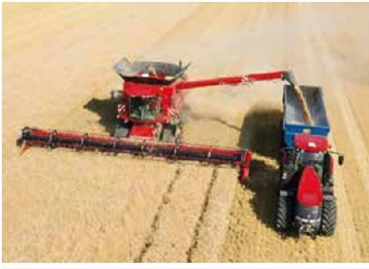
AFS AccuGuide: Spurführung auf der Basis von GPS und GLONASS – Genauigkeit bis zu 2,5 cm verfügbar.
