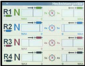
Bedienen und Konfigurieren Sie die Steuerventile über den AFS Pro 700™ Monitor.
