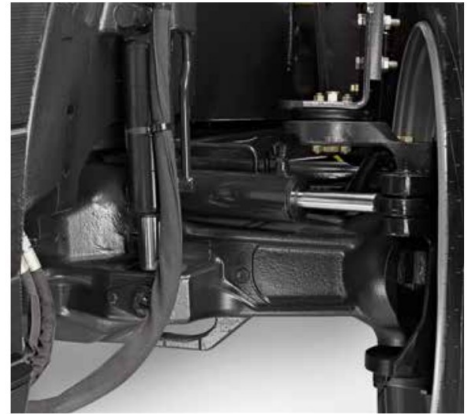
Vorderachsfederung für höchste Stabilität, sanfte Fahrt und volle Leistung mit optimaler Bodenhaftung
