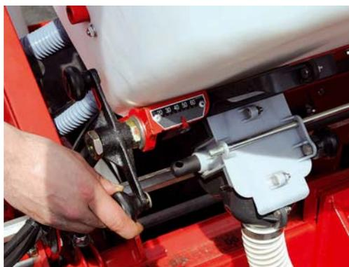
Tramogge per concimazione di diverse dimensioni possono equipaggiare molti modelli di MAXIMA 2 già in servizio. Questa attrezzatura opzionale è montata sul telaio della macchina formando un assieme monoblocco. A richiesta è disponibile anche una coclea per il caricamento del concime sfuso.
