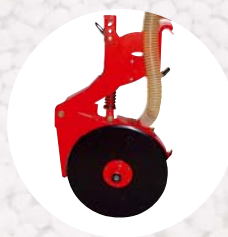
Дисковый безостановочный сошник для минимальных технологий
