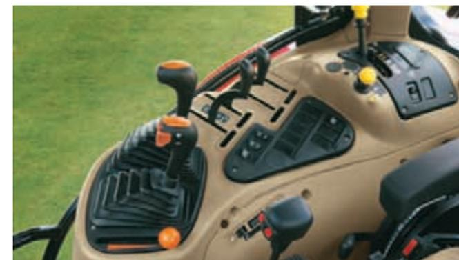
Funzionalità assoluta per i trattori Maxxum. È possibile scegliere fra la trasmissione Powershift a 2 velocità 24x24 e ...
