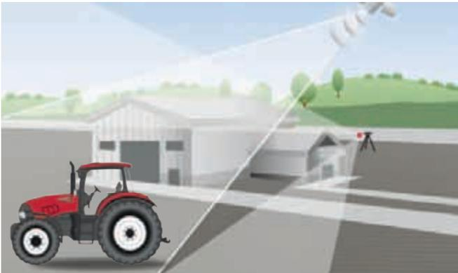
**Il sistema xFill assicura fino a 20 minuti di correzione in caso di perdita del segnale.**
