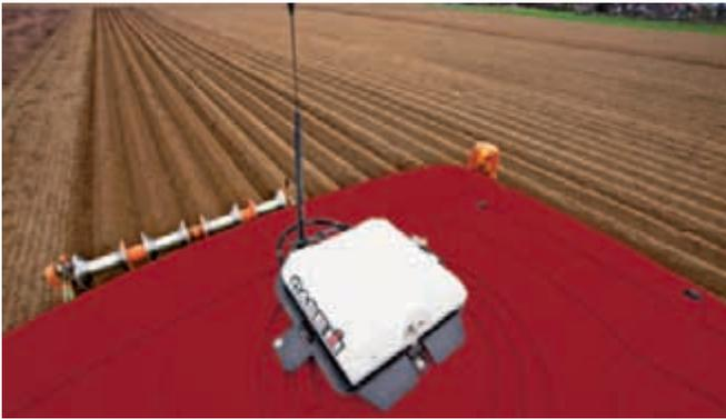
**AFS AccuGuide™: sistema di guida con GPS e GLONASS per la massima precisione indipendentemente dalle condizioni del prodotto. Livello di precisione fino a 2,5 cm.**
