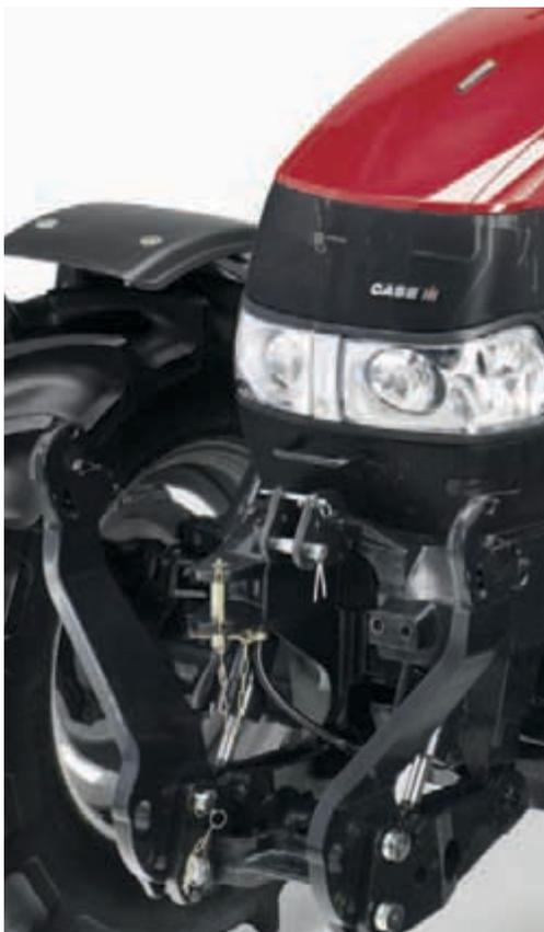
Sollevatore anteriore completamente integrato con capacità di sollevamento di 3.800 kg. Gestione del sollevatore anteriore disponibile a richiesta per i modelli Maxxum Multicontroller e CVX.
