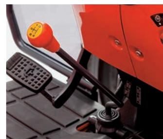
*Einfach zu bedienendes Hauptschaltgetriebe*
