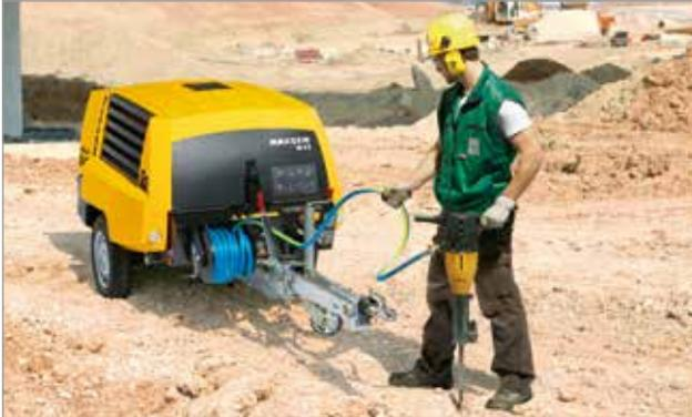
Im Volumenstrombereich von 2 bis 5,6 m<sup>3</sup>/min bekommen diese MOBILAIR-Baukompressoren nicht so schnell „kalte Füße“: Die patentierte KAESER-Anti-Frost-Regelung stimmt die Betriebstemperatur der Anlagen automatisch auf die Umgebungstemperatur ab. Dies schützt, zusammen mit dem optionalen Werkzeugöler, die Druckluftwerkzeuge vor dem Einfrieren und erhöht deren Verfügbarkeit und Lebensdauer.
