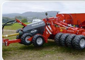
*Um die Arbeit der Kreiselegge zu erleichtern und den Leistungsbedarf zu senken, kann das Gewicht auf die Vorderräder verlagert werden.*
