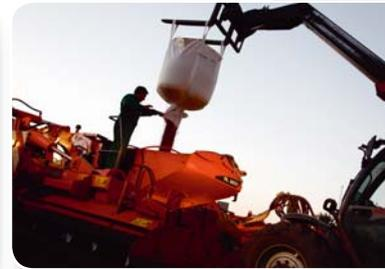
**Befüllschnecke:** Mit der Edelstahlbefüllschnecke als Sonderausstattung, beladen sie den MODULINER in 6-8 Minuten.
