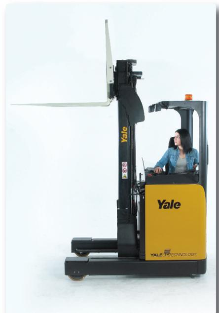
disposición de engranaje sobre engranaje ofrece un control preciso de la dirección. Durante el arranque, el volante se centra automáticamente. Una placa separable permite acceder a la rueda de tracción / grupo reductor durante el servicio. El compartimento del motor, incluyendo el motor de elevación, está ventilado.
