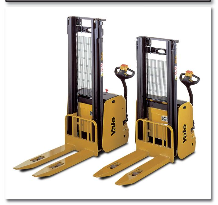
La elevada eficiencia energética y rendimiento del motor permiten operar por un tiempo prolongado. En todo momento se dispone de un control progresivo suave. El controlador cuenta con frenado automático (frenado por corriente de inversión) y con frenado regenerativo al soltar los botones de mariposa, así como con protección anti-retroceso/arranque en pendientes.
