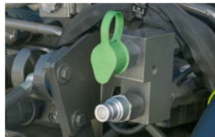
Hydrauliczny hamulec przyczepy zapewnia elastyczność także podczas transportu.*
