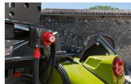
Rozłącznik akumulatora znajduje się w tylnej części kabiny i jest łatwo dostępny.
