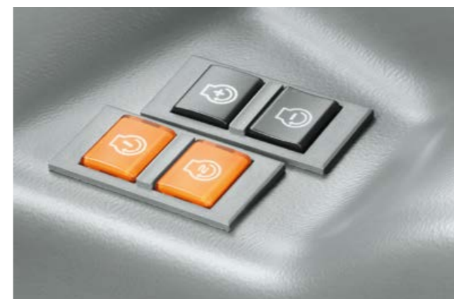
Prace z WOM wykonywane są przez NEXOS wyjątkowo łatwo – dzięki seryjnej pamięci prędkości obrotowej silnika.
