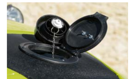
Praktycznym rozwiązaniem jest otwór w masce silnika. Umożliwia to łatwe otwieranie i napełnianie bezpiecznie ułożonego pod nią zbiornika paliwa.
