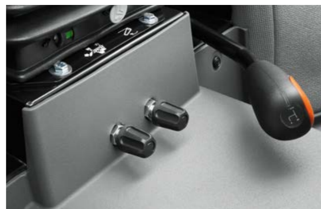
Również w przypadku mechanicznych podnośników tylnych pod siedzeniem operatora możliwa jest precyzyjna regulacja prędkości opuszczania i czułości siły uciążu.
