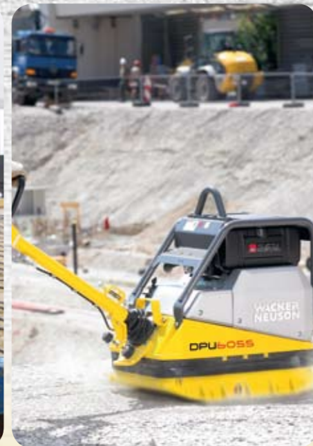
Fase 2: Il terreno viene preparato e compattato prima della lavorazione successiva. A seconda della grandezza della superficie Wacker Neuson offre una vasta gamma di piastre vibranti.
