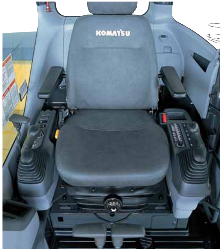
Sedile ammortizzato con cintura di sicurezza retrattile
