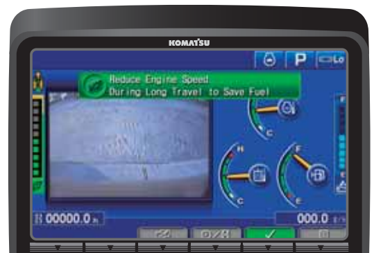
Bilder der Rückfahrkamera werden auf dem optimierten Monitorsystem ausgegeben. Eco-Anzeige und Kraftstoffverbrauchsanzeige erleichtern den kraftstoffsparenden Betrieb.
