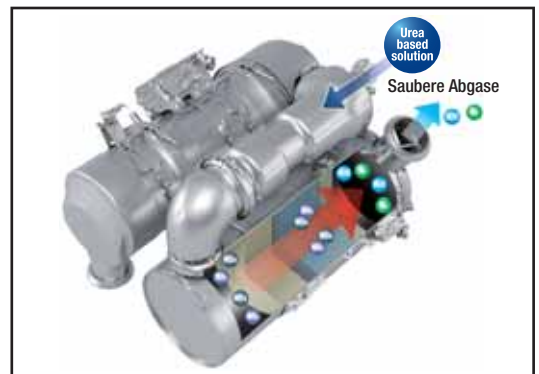
Neues Abgasnachbehandlungssystem kombiniert Komatsu Dieselpartikelfilter (KDPF) und selektive katalytische Reduktion (SCR) zur Erfüllung der Abgasvorschriften gemäß EU Stufe IV.
