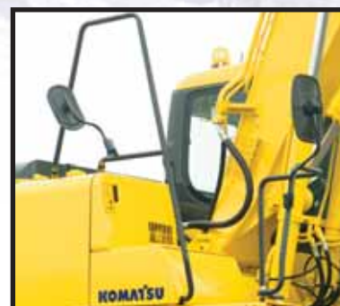
Masivní zábradlí pro bezpečný přístup
