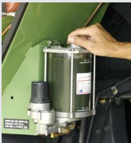
Für minimalen Wartungsaufwand und eine lange Lebensdauer ist die Presse serienmäßig mit einer elektronischen Knoter-Zentralschmierung ausgestattet.
