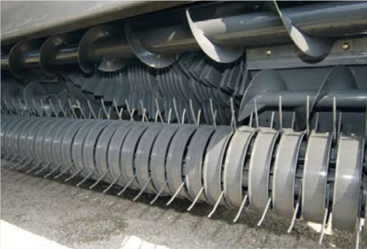
Die 2,26 m breite Power Pick-Up ermöglicht einen perfekten Gutfluss und maximalen Durchsatz.
