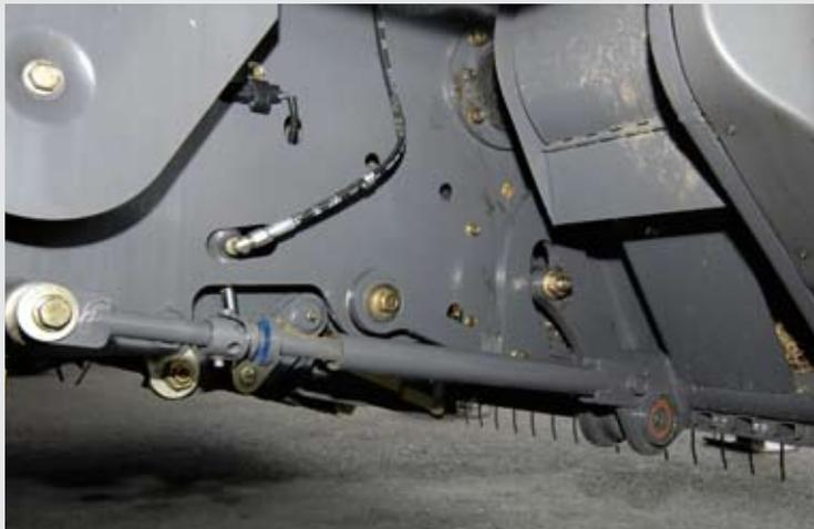
Die Pick-up wird von einer Torsionsfeder entlastet. Die Tasträder werden dabei nicht zur Führung am Boden benötigt, sondern schützen die Zinken der Pick-up bei schneller Fahrt.
