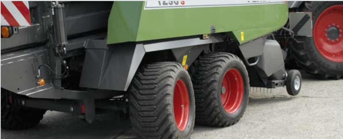
Alle vier Modelle sind serienmäßig mit einer 60 km/h Tandem-Lenkachse ausgestattet. Die Tandemachse ist mit Reifen der Größe 550/45-22,5 ausgerüstet.
