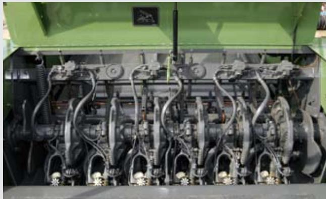
Eine einfache Zugänglichkeit zu den Knotern gewährleistet das klappbare Querstromgebläse.
