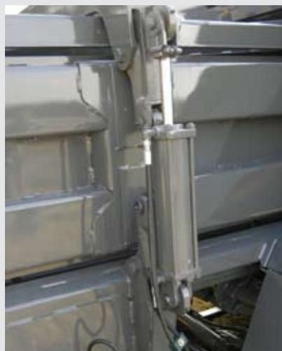
Das Dach und die Seitenwände werden über doppelwirkende Hydraulikzylinder am Presskanal gesteuert.
