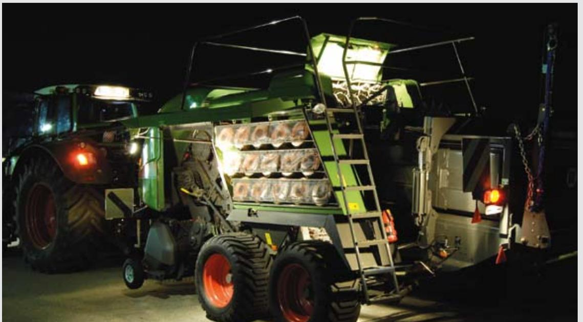
**Das neue Design der Fendt-Quaderballenpressen kann sich nicht nur sehen lassen, es ist zudem sehr funktional. Die großen sich öffnenden Seitenklappen ermöglichen einen optimalen Überblick über den Füllstand des Garnkastens. Der Garnvorrat von 30 Rollen sorgt auch an langen Arbeitstagen für ausreichend Material. Durch die Lagerung der Garnrollen in einem Winkel von 30 Grad ist ein Verrutschen oder auch Verhaken des Garnes ausgeschlossen.**
