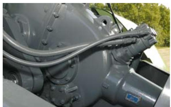
Die zentrale Kraftübertragungsstelle der Presse: Das Kegelstirnradgetriebe
