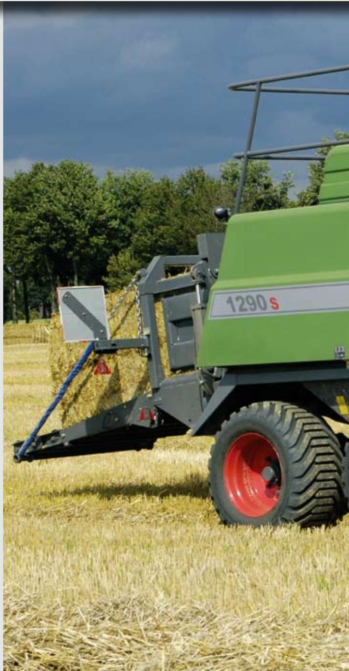
**Die Aufnahme des Erntegutes trägt entscheidend zur Leistungsfähigkeit einer Ballenpresse bei. Die 2,26 m breite Pick-Up der Fendt-Quaderballenpressen sorgt von Anfang an für eine rechsäubere Erntegutaufnahme. Die sich anschließenden Zentrierschnecken leiten das Gut wirkungsvoll in die Vorpresskammer. Damit wird eine hohe Durchsatzleistung erzielt.**
