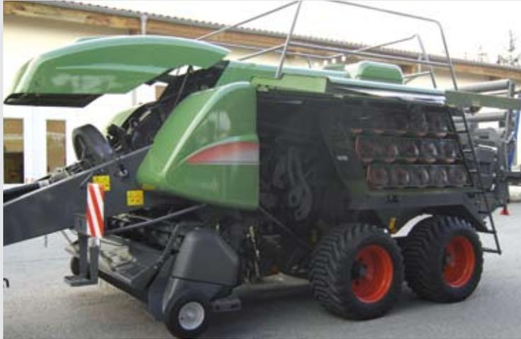
Das einzigartige Querstromgebläse reinigt kontinuierlich den Knoterbereich. Mit einer Luftgeschwindigkeit von 140 km/h wird dieser Bereich immer sauber gehalten und bleibt frei von Verschmutzungen.
