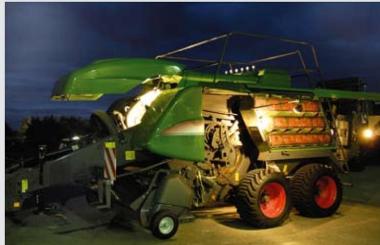
Die Wartung nach getaner Arbeit sichert den sorglosen Einsatz für den nächsten Tag. Mit dem innovativen Beleuchtungskonzept können Sie auch in der Dämmerung oder bei Nacht alle zu schmierenden Stellen einsehen.
