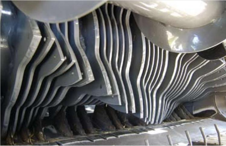
Der spiralförmige Schneidrotor mit Doppelzinken gewährleistet einen exakten Schnitt.
