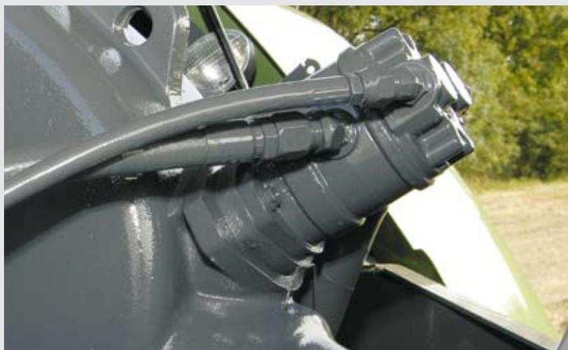
Die drehbare Anhängervariante kann so montiert werden, dass entweder in Oben- oder Untenanhängung gefahren werden kann.
