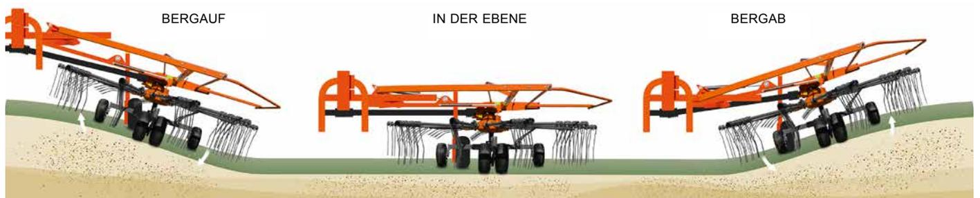
Die Rotoren können in alle Richtungen der Kontur des Bodens folgen.
