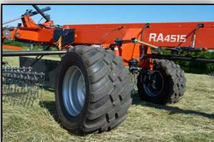
Der RA4515 wird optional mit einer hydraulisch lenkbaren Achse geliefert. Dadurch ist der Schwader noch wendiger und die Nachlaufeigenschaften an starken Seitenhängen wird deutlich verbessert.
