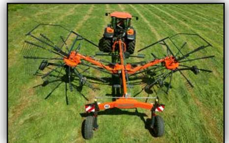
...bis 7,80 m hydraulisch zu verstellen.
