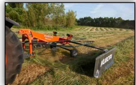
Der 3-Punkt Nachlaufbock hat einen extrem großen Schwenkbereich und ermöglicht so optimales Nachlaufverhalten auch in engen Kurven.
