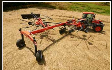
Natürlich verfügt der RA2069 über 80° Einschlagwinkel am Anbaubock.
