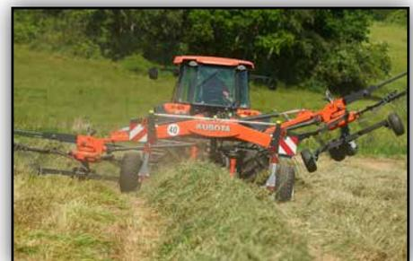
Optional ist der Einzelaushub der Kreisel erhältlich. Dieser ist bei der Hydro - Baureihe Serie.
