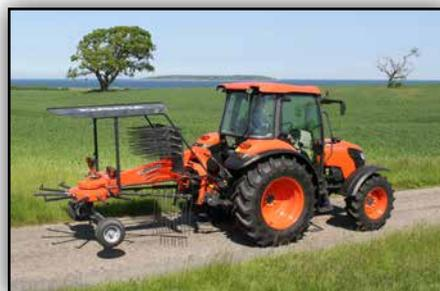
Um die Transport-/Unterstellbreite zu reduzieren, lassen sich bei allem Einkreiselschwadern die Zinkenarme abnehmen und die Schutzbügel nach oben klappen.
