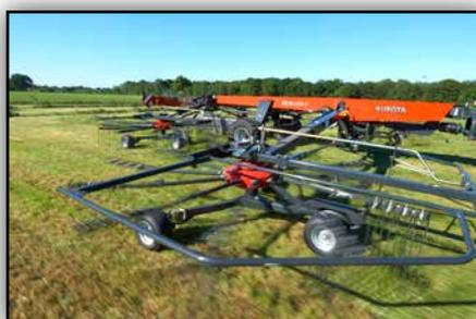
Die Arbeitsbreite von 10,00–12,50 m wird hydraulisch eingestellt. Ebenso kann über die hinteren Kreisel die Schwadbreite von 1,20–1,90 m stufenlos eingestellt werden.
