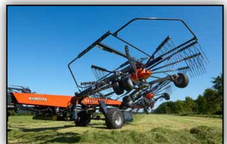
Große Aushubhöhe der Rotoren. Dies ist gerade bei großvolumigen Schwaden von Vorteil.
