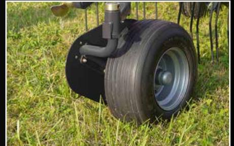
Als Option können die Schwader mit einem zusätzlichen Stützrad ausgestattet werden, für eine noch bessere Boden Anpassung.
