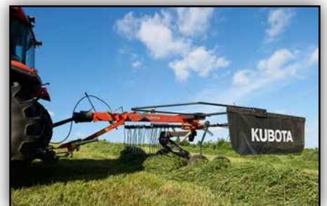
RA1042T und RA1047T besitzt ein hydraulisches Schnellaushubsystem, um die Maschine zum Überqueren der Schwaden rasch auszuheben. Die Aushubhöhe beträgt 50 cm.
