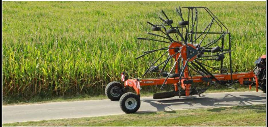
Eine Arbeitsbreite von 9,00 m und eine Transportbreite unter 4,00 m wird erreicht, ohne die Zinken zu entfernen.
