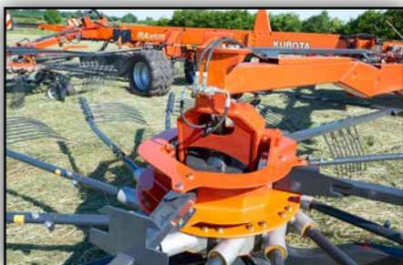
Die Rotoren können jeder einzeln oder auch alle gemeinsam hydraulisch in der Höhe eingestellt werden. Dies geschieht über das Bedienterminal..
