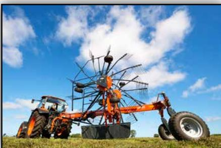
Alle Funktionen werden hydraulisch aus der Schlepperkabine gesteuert.
