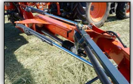
Hydraulisch einstellbare Bodendruckentlastung an den vorderen Kreiseln.
