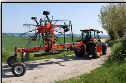
Um die Transport-/Unterstellhöhe zu verringern verfügt der RA2076 über abnehmbare Zinkenarme. Das Schwadtuch klappt automatisch ein.
