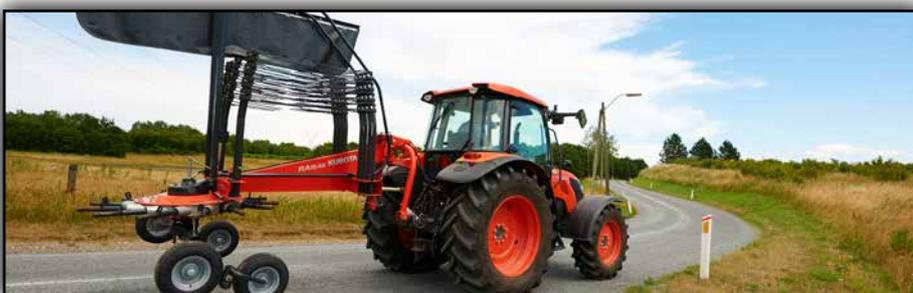
Die stabilen Schutzbügel werden nahe am Hauptrahmen hoch geschwenkt und automatisch verriegelt. Das Schwadtuch selbst ist drehbar aufgehängt, damit es in Transportstellung nach unten pendeln kann.
