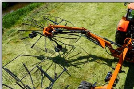
Die Arbeitsbreite lässt sich in einem Bereich von 9,80 bis 15,00 m hydraulisch verstellen.
