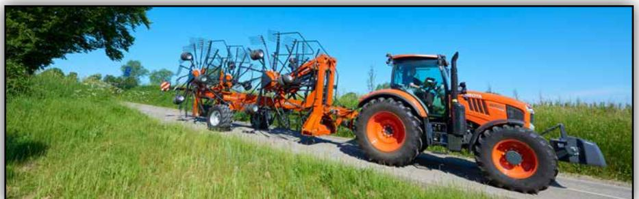
Trotz Kreiseldurchmesser von 3,85 m bleibt die Maschine in der Gesamthöhe unter 4,00 m! Dank eines ausgeklügelten Klappmechanismus müssen die Zinkenarme zum Straßentransport nicht abgenommen werden.
