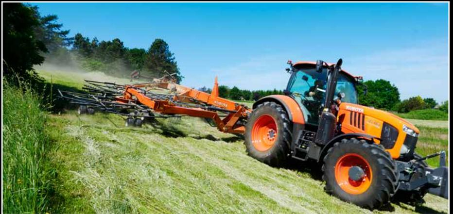
Die einzigartige Ellenbogenkonstruktion der vorderen Kreisel ermöglicht dem Fahrer einen sehr guten Überblick über die gesamte Arbeitsbreite der Maschine.
