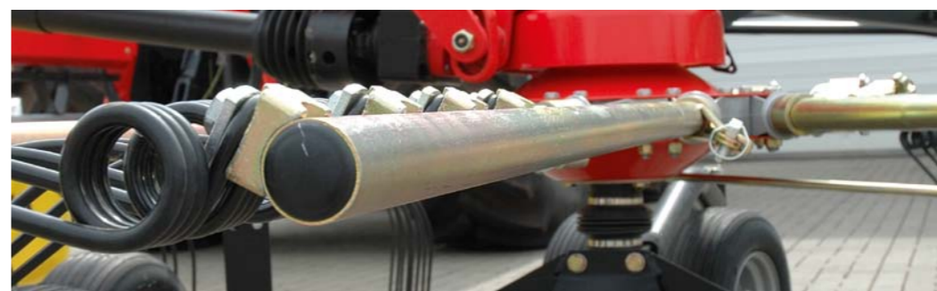
Całkowicie gładka przednia powierzchnia ramienia zębów
