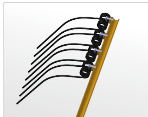
Każdy z zębów jest przykręcony oddzielnie śrubami pod ramieniem
