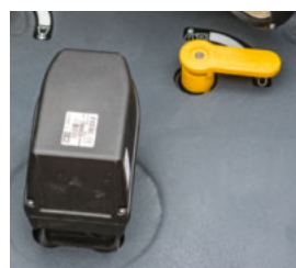
■ Unità di comando Optiflow: Sistemata accanto all'incorporatore per un facile controllo di tutti gli agitatori e delle funzioni durante il processo di riempimento.
