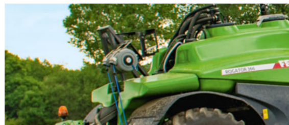
□ Die praktische Schlauchtrommel am hinteren Ende der Spritze erlaubt die schnelle und unkomplizierte Reinigung.
