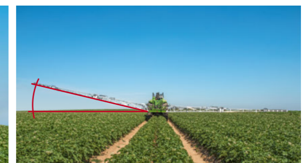
Zur perfekten Anpassung an Ihren Pflanzenbestand lassen sich die Bodenkontur oder der Pflanzenbestand zur Höhenführung nutzen. Ebenso ist eine Hybridregelung möglich.
