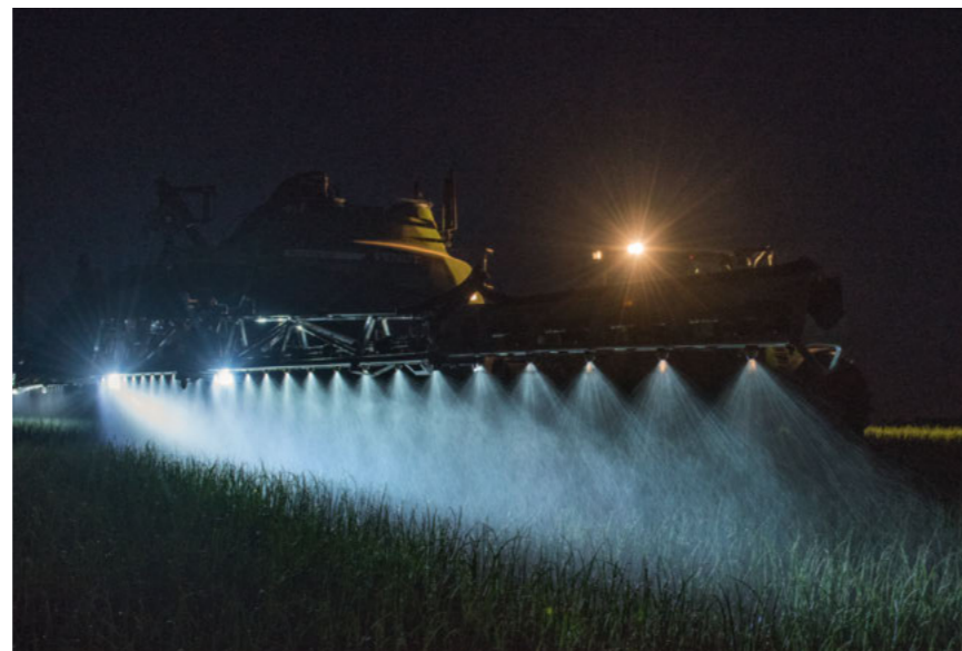
■ LED Scheinwerfer zur optimalen Sicht auf die Düsenfächer. Optional sind auch 2 oder 4 blaue LED-Scheinwerfer erhältlich. Die Scheinwerfer sind zum Schutz vor Ablagerungen vor der Düse montiert.
