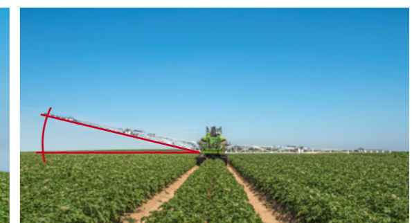
Odległość od podłoża lub fanu można wykorzystać jako punkt odniesienia do regulacji wysokości, aby precyzyjnie ustawić belkę względem danej uprawy. Możliwa jest również regulacja mieszana.
