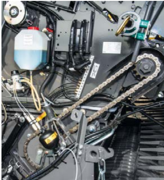
■ Le réservoir de taille généreuse alimente les pinceaux ou les éponges qui répartissent uniformément l'huile sur les chaînes.
