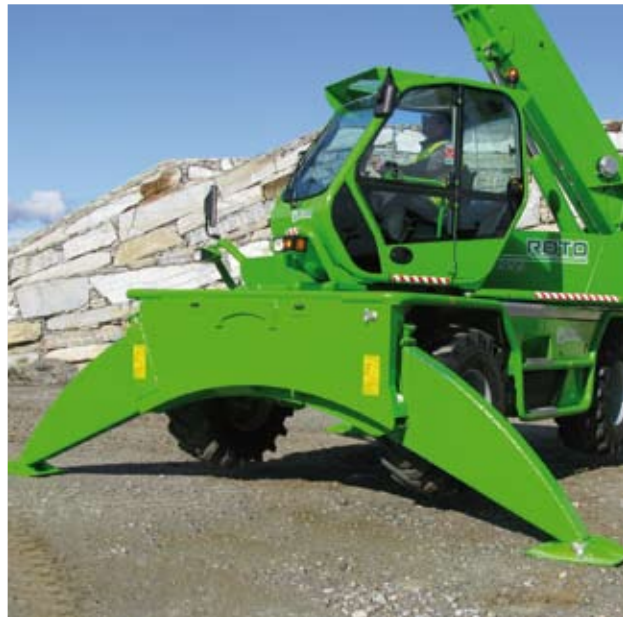
Abstützungen mit kombiniertem Ausfahren und Positionieren auf dem Roto Serie 600. Das exklusive System von Merlo der Stabilisierung und des automatischen Ausgleichs der Maschine vereinfacht die Positionsvorgänge und garantiert so höchste Sicherheit.
