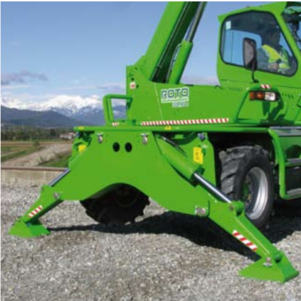
Abstützungen mit unabhängigem Ausfahren und Positionieren auf Roto Serie MCSS. Für den Einsatz auf Bereichen mit geringem spezifischen Widerstand ist der Einsatz von zusätzlichen Platten mit großer Oberfläche vorgesehen, um ihre Vielseitigkeit noch zu erhöhen.
