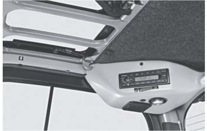
Interfaz de comunicación: radio con puerto USB y sistema manos libres Bluetooth
