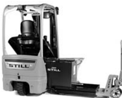
3) Výměna baterie pomocí standardního paletového vozíku, nízkozdvíhacího vozíku a podstavce pro výměnu baterie
