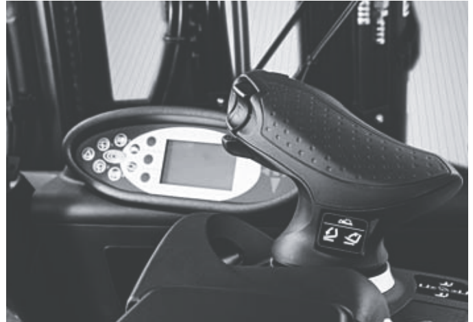
Joystick 4Plus für angenehmes und ermüdungsfreies Arbeiten
