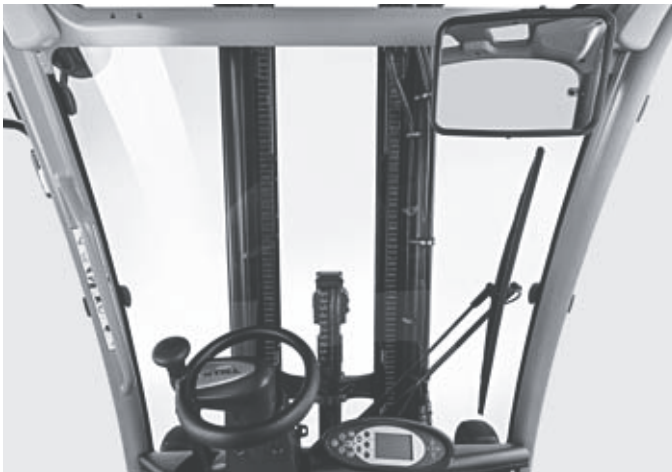
Optimale Sicht nach vorn dank schmaler Schutzdach- und Hubgerüstprofile
