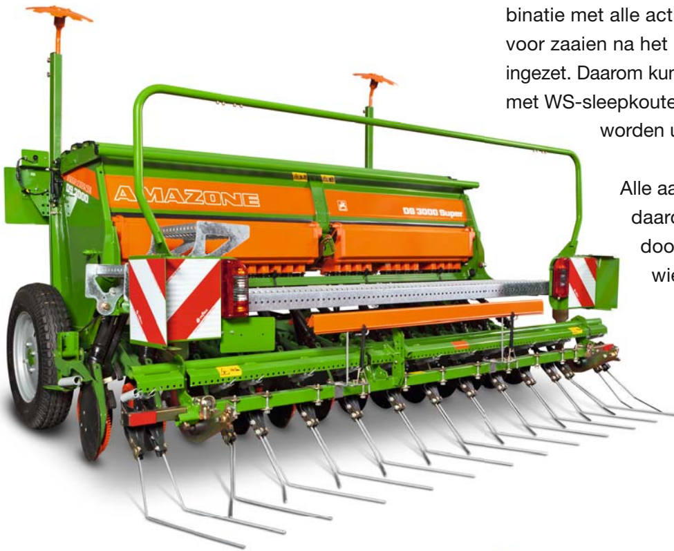
D9 3000 Super met 3 m werkbreedte en RoTeC-Control-schijfkouters (hier met laterale markeringsborden speciaal voor Frankrijk)
