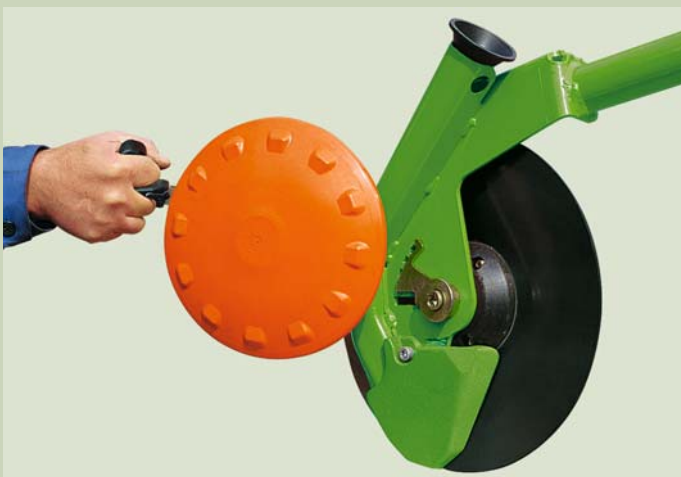
Voor zeer diep zaaien wordt de dieptegeleideschijf aan een handgreep geheel weggenomen.
