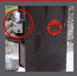
Die Schlagzahlerhöhung, ab Modell SCB 9, lässt das "Herz" im Hammer individuell einstellen. Das Schlagwerk stellt mehr Leistung zur Verfügung und erhöht die Produktivität.
