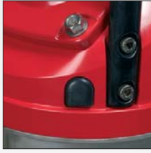
Ilmaventtiili Jäähdyttää pumppua, jos se käy kuivana
