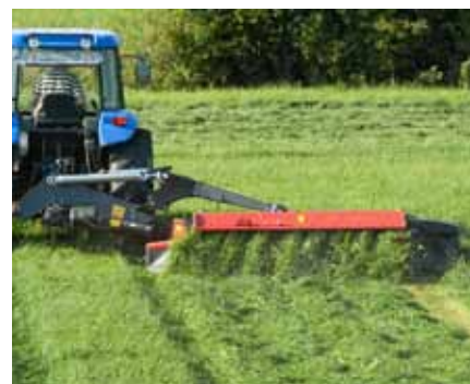
Gyors váltás keskeny rend készítéséről széles rend készítésére.
