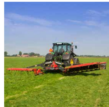
Le unità di taglio possono essere sollevate indipendentemente.
