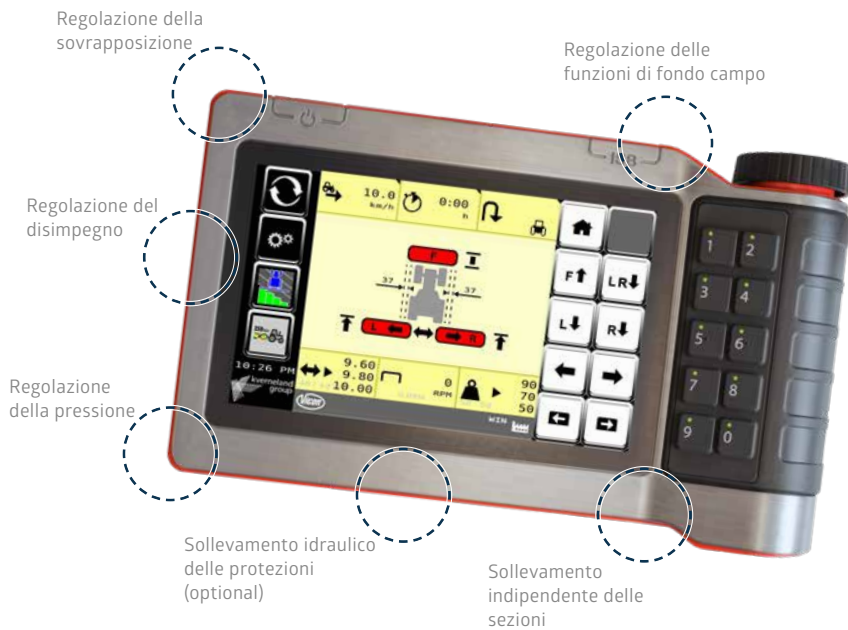
Joystick Portus per la gestione di tutte le funzioni della macchina.
