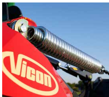
Le molle di sospensione maggiorate assicurano una pressione costante al terreno.
