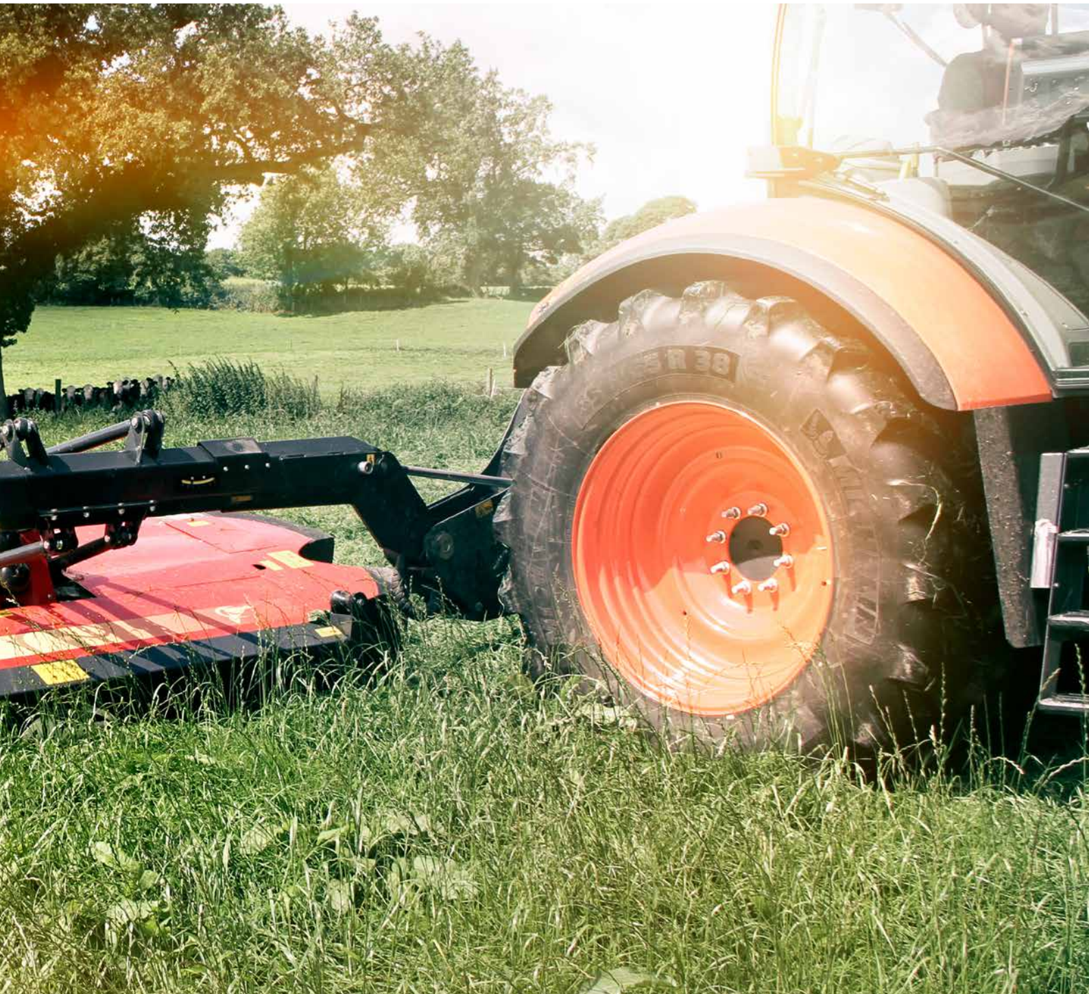
Falciaccondizionatrice portata posteriore 3.18 e 3.50m di larghezza di lavoro
