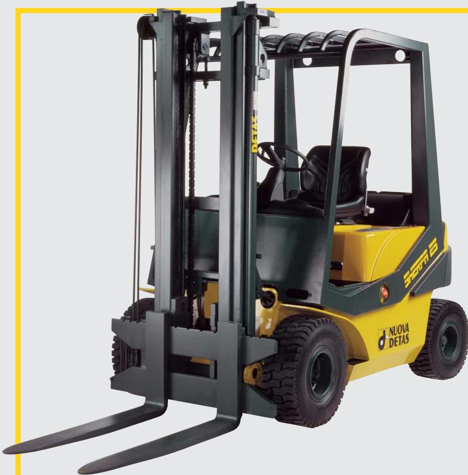
Die Gabelstapler der Serie **SHERPA 25-30** zeichnen sich durch kompakte Bauweise und modernes Design aus. Die günstigen Abmessungen und eine optimale Gewichtsverteilung auf Antriebs- und Lenkachse ermöglichen den Einsatz der Stapler auch unter schwierigen Arbeitsbedingungen, zeichnen diese durch beste Resttragfähigkeiten auch bei großen Hubhöhen aus und erfüllen somit höchste Leistungen.
