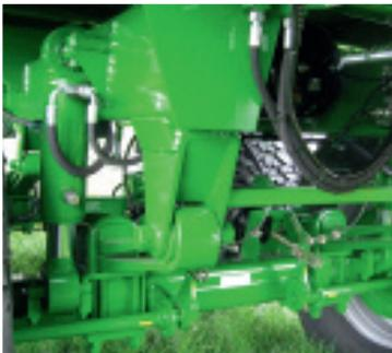
Der hydraulische Achsausgleich verteilt die Belastung gleichmäßig auf beide Achsen. Der große Achsausgleich (bis 300 mm) sorgt für herausragende Fahreigenschaften besonders auf unebenem Gelände.
