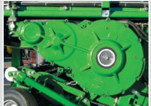
Das robuste, schwimmend aufgehängte Stirnradgetriebe als geschlossenes Ölbadgetriebe mit einem Wellendurchmesser von 120 mm ist für größte Schlepper ausgelegt.
