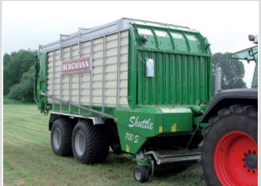
Der Shuttle-Aufbau ist nach neuesten Gesichtspunkten konzipiert: Der Leiterraum mit geschlossenem Ganzstahlaufbau und pulverbeschichteten, verzinkten Trapezblechprofilen sichert eine lange Nutzungsdauer. Für eine optimale Entladung ist an der Stirnseite eine Heckklappen-Stellungsanzeige montiert.
