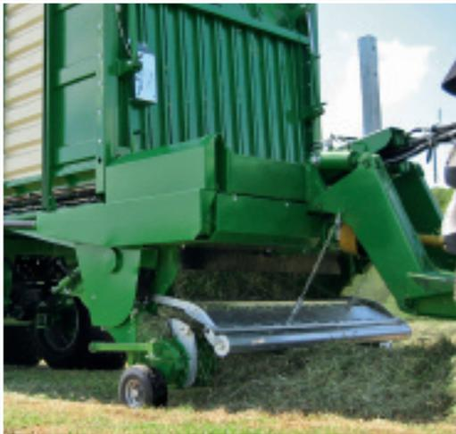
Optimaler Materialfluss - ohne Verengung - von der Pick-up mit Schwadrolle über den Rotor bis in den Laderaum. Zum Schutz der Pick-up ist deren Antrieb mit einer Überlastkupplung ausgestattet.
