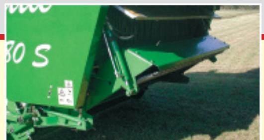
Die 34 mm-Kurzschnitt-Einrichtung mit 53 Messern auf einer Ebene ist ein Garant für beste Silagequalität. Jedes Messer ist einzeln fremdkörpergesichert. Der werkzeuglose Aus- und Einbau erfolgt in wenigen Sekunden.
