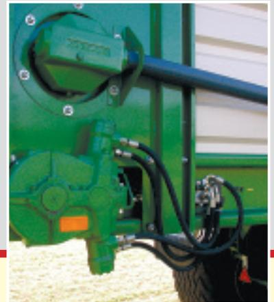
Der reversierbare Transportboden ist über einen serienmäßigen, hydraulischen Zwei-Stufen-Antrieb mit Eilgangschaltung ausgestattet. Der Walzenantrieb erfolgt mit einem Aufsteck-Winkelgetriebe (700 S/820 K).
