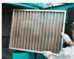
Normalerweise müssen beim Kühlsystem die verschiedenen Komponenten wie z.B. Kühler, Ölkühler und Ladeluftkühler alle unterschiedlich überprüft und gereinigt werden. Mit dem iNDR-Filter gibt es jedoch nur einen Filter an einem Ort. Falls er bei der Inspektion vor dem Maschinenstart schmutzig aussieht, kann er schnell und einfach gereinigt werden.
