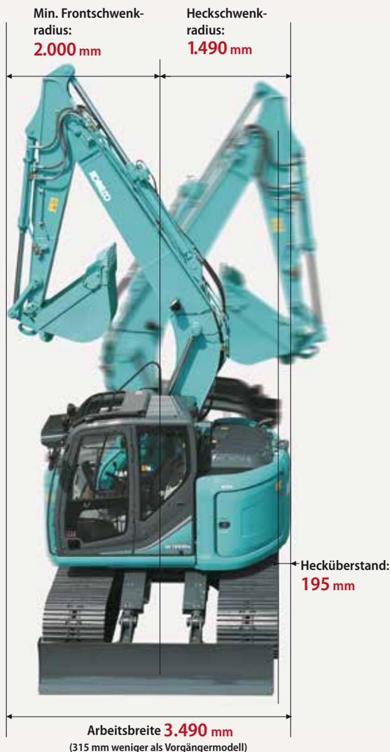
\*Die Arbeitsbreite (180°) entspricht der Summe des minimalen vorderen Schwenkradius und dem Heckschwenkradius.
