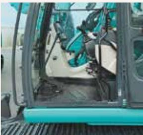
Einfacher Ein- und Ausstieg durch breiten Kabinenzugang und in die Bedienhebel-Konsole integrierten Sicherheits-Sperrhebel.
