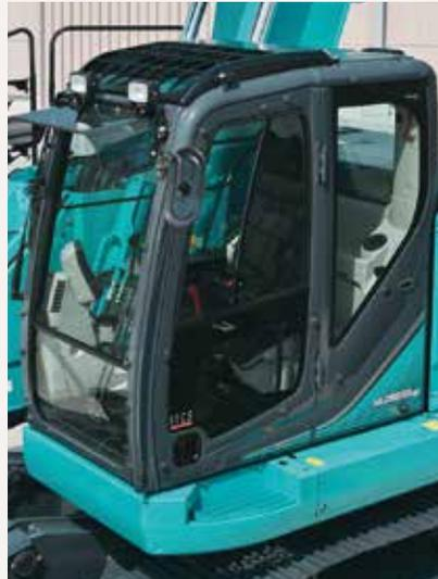
Die neu entwickelte, ROPS (Überrollschutz)-konforme Kabine erfüllt die ISO-Normen (ISO-12117-2:2008) und sorgt für mehr Sicherheit für den Fahrer, falls die Maschine umkippt.
