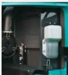
Die Außenluft wird zur Staubbefreiung direkt durch den Einlasskanal in den iNDR-Filter geleitet. Der Filter verfügt über ein 60-Maschen-Sieb; das heißt, dass er pro Zoll sowohl vertikal als auch horizontal sechzig Löcher und eine breite Ziehharmonika-Flächenstruktur hat, die nicht verstopft.
