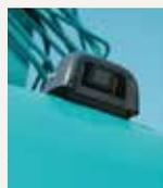
Eine Rückfahrkamera ist zur einfachen Sicherheitskontrolle des Bereichs hinter der Maschine serienmäßig installiert. Das Bild erscheint auf dem Farbmonitor.
