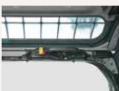
Entriegelung per Knopfdruck für einfaches Öffnen und Schließen der Frontscheibe
