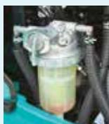
Prefiltro del carburante con separatore d'acqua incorporato
