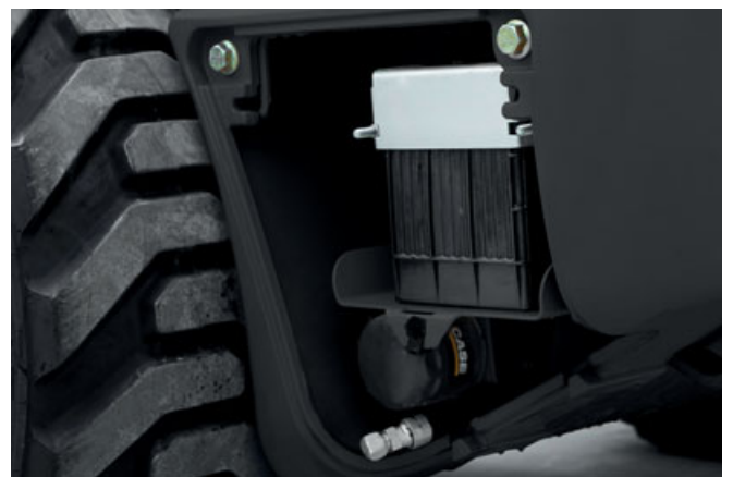
Clevere Lösung: der Zugang zu Batterie und Öl-ablassventilen Die Batterie und die tropfsicheren Ablassventile sind schnell zu erreichen. Sie liegen seitlich im Heck der Maschine unter einer stabilen Abdeckung. Wartungsarbeiten sind so schnell erledigt.
