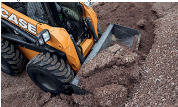
Schaufellafer direkt am fahrwerksrahmen die robuste lösung für mehr schubleistung
