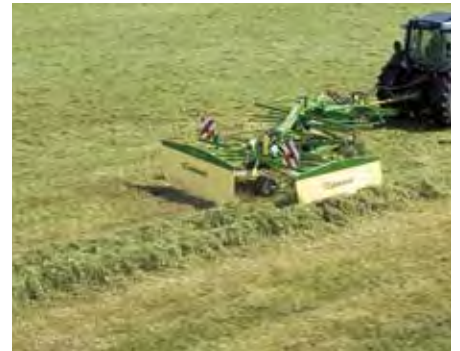
Doppelschwadablage Ein Doppelschwad aus 12,40 m
