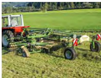
Swadro TC 640 und Swadro TC 680 Arbeitsbreite: 5,70 m – 6,40 m und 6,80 m
