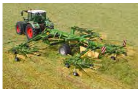
Vierkreisel-Mittelschwader Swadro 1400 und 1400 Plus Variable Arbeitsbreiten von 11,00 m bis 13,50 m
