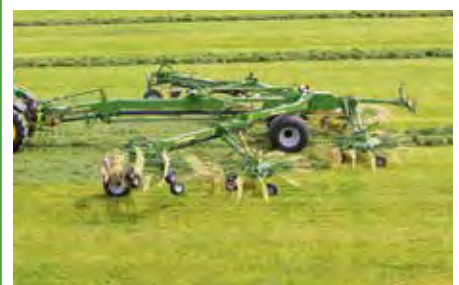
Sechskreisel-Mittelschwader Swadro 2000 Variable Arbeitsbreiten von 11,00 m bis 19,00 m
