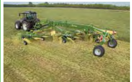
Zweikreisel-Seitenschwader Swadro 1010 Arbeitsbreiten von 9,70 m
