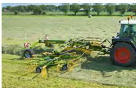
Zweikreisel-Mittelschwader Swadro TC und TC Plus Variable Arbeitsbreiten von 5,70 m bis 10,00 m
