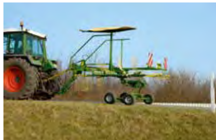
Einkreiselschwader Swadro, gezogen Arbeitsbreiten von 3,80 m bis 4,60 m
