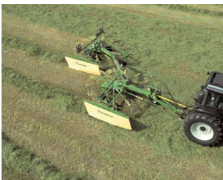
Formación de dos hileras Rastrillado de 6,80 m en dos hileras
