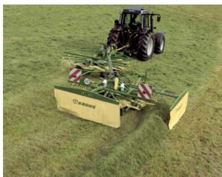
Formación de una sola hilera Rastrillado de 6,20 m en una sola hilera
