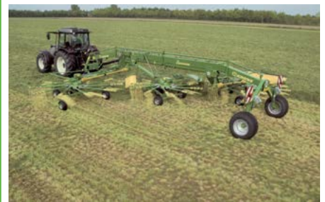
Modelo de descarga lateral con dos rotores Swadro 1010 Ancho de trabajo 9,70 m
