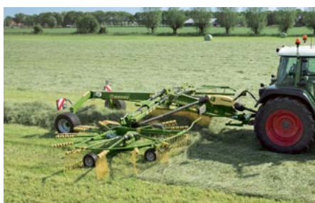
Modelos de descarga central con dos rotores Swadro TC y TC Plus Anchos de trabajo variables de 5,70 m a 10,00 m
