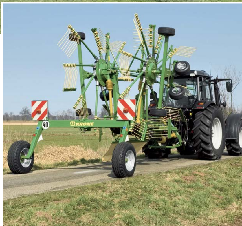
Il carrello con carreggiata larga e i grandi pneumatici 10.0/75 - 15.3/8 PR è strutturato per velocità fino a 40 km/h e assicura la massima sicurezza nei trasferimenti veloci.
