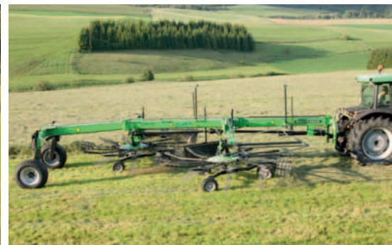
Die niedrige Höhe des hinteren Rahmens erhöht die Stabilität.
