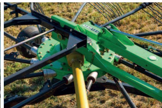
Die Verstellung der Schwadbreite erfolgt hydraulisch vom Schlepper aus.
