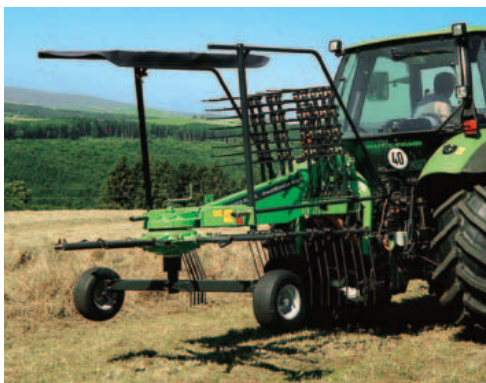
SwatMaster 3921 in Transportstellung.
