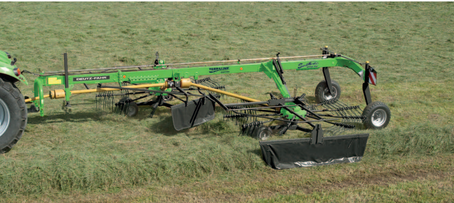
SwatMaster 6952 mit 6,90 m Arbeitsbreite.
