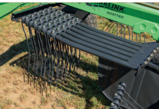
Gut zu erreichende Ablagen für abgenommene Zinkenarme.
