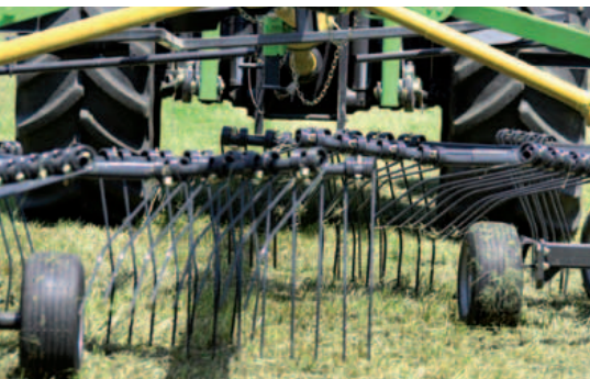
Große Überlappung zwischen den Kreiseln für Einzelschwad. SwatMaster 6952 mit 6,90 m Arbeitsbreite.
