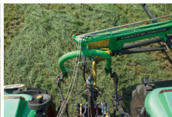
Über 80° Einschlagwinkel am Anbaubock.
