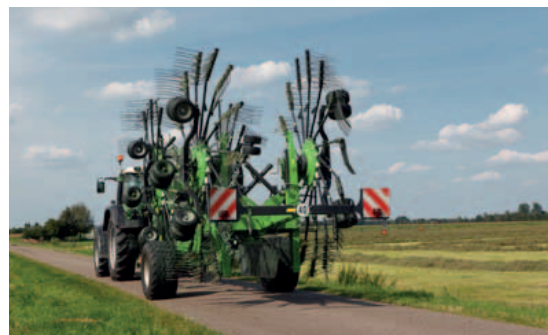
Transporthöhe unter 4,00 m – mit aufgesteckten Zinkenarmen!
