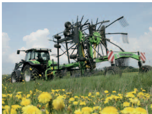
SwatMaster 11041 in Transportstellung.
