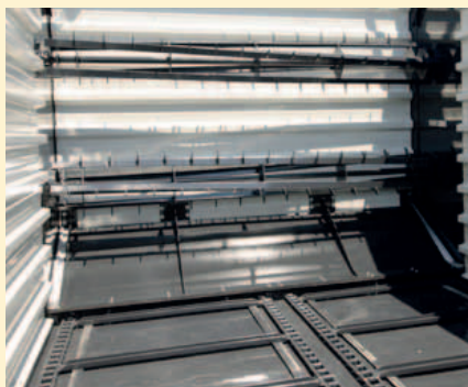
Eine zusätzliche Platte mit Bürsten an der Heckklappe garantiert, dass kein Material im geschlossenen Zustand verloren geht.
