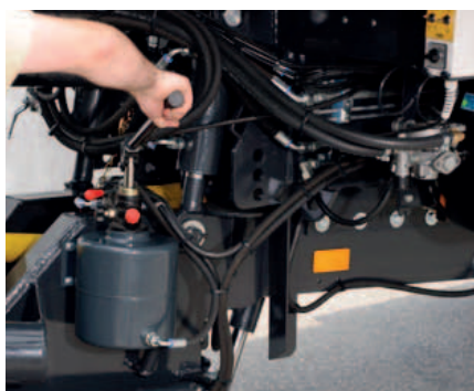
Der T-Rex kann optional mit einer Handpumpe für den Stützfuß ausgestattet werden.
