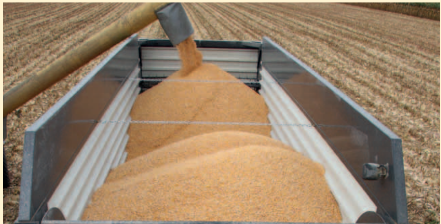
Der T-Rex 452 mit Getreide-Kit für den Transport von Raps, Weizen und Körnermais.
