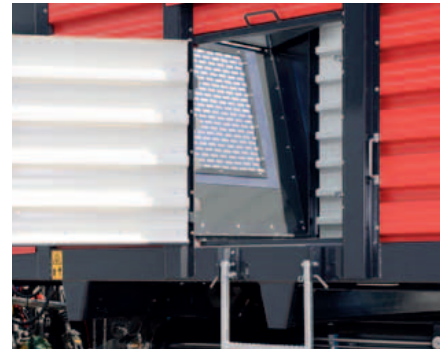
Einfacher Zugang in den Laderaum wird durch die optionale Einstiegstür mit Leiter ermöglicht.
