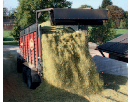
Die riesige Heckklappe in Kombination mit dem Kratzboden verspricht ein schnelles und effizientes Entladen. Die Sensor gesteuerte Heckklappe wird hydraulisch betätigt und mechanisch verriegelt.
