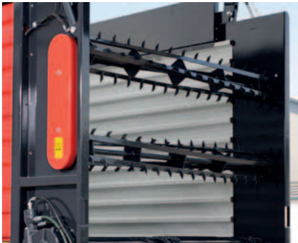
Die zwei offenen Dosierwalzen des T-Rex 452 werden mechanisch über eine wartungsfreundliche Welle angetrieben und helfen das Erntegut in einer gleichmäßigen Schicht abzulegen.
