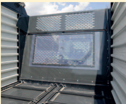
Bei dem optionalen Getreide-Kit ist der Laderaum zum Kratzboden mit starken Bürsten abgedichtet. Der untere Teil der Frontwand ist mit einer Industrie-Folie korndicht abgedeckt.
