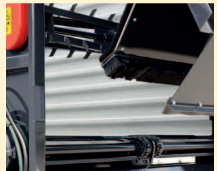
Der Kratzboden wird komplett von der Heckklappe abgedeckt sobald diese geschlossen ist um sicher zu stellen, dass kein Material während des Transports verloren geht.
